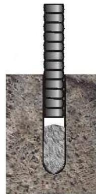
12. Bitte berühren Sie nicht den Bolzen oder Anker bis die Mischung geliert hat und belasten Sie den Anker nicht, bis die Aushärtung gemäss Abbildung 1 abgeschlossen ist. (siehe Zeittabelle Aushärtung)
